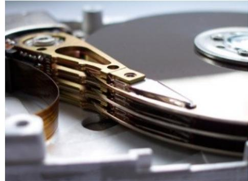
Dès 1956, dans un disque dur, on trouve des plateaux rigides en rotation. **Chaque plateau est constitué d'un disque réalisé généralement en aluminium**, qui a les avantages d'être léger, facilement usinable et paramagnétique (ne possède pas d'aimantation spontanée mais qui, sous l'effet d'un champ magnétique extérieur, acquiert une aimantation dirigée dans le même sens que ce champ d'excitation).
