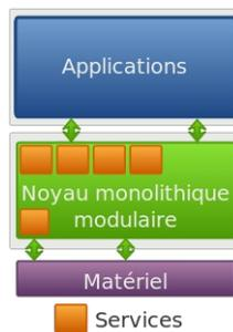
Dans ce type de noyau, seules les parties fondamentales du système sont regroupées dans un bloc de code unique (monolithique). Les autres fonctions, comme les pilotes matériels, sont regroupées en différents modules qui peuvent être séparés tant du point de vue du code que du point de vue binaire. La très grande majorité des systèmes actuels utilisent cette technologie.
